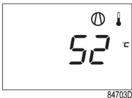
Главный экран с температурой (остановлен компрессор)
