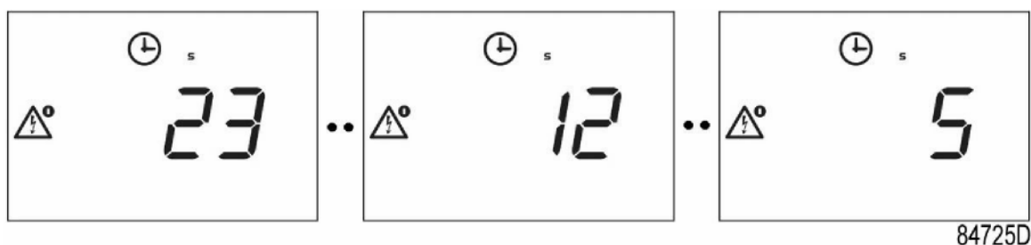
Пример отсчета времени задержки автоматического перезапуска после сбоя питания.
